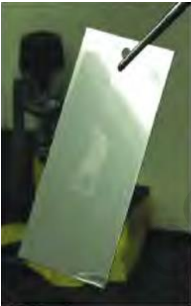
图5.8：用于实验室清洁评估的不锈钢试样图像
